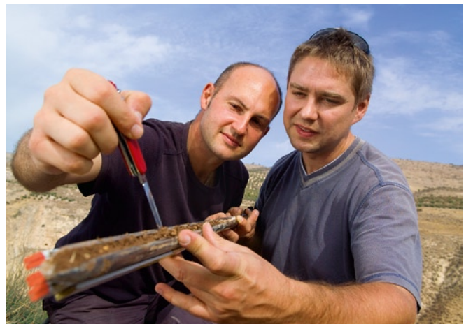
Bodenprobenahme im Nahen Osten von Dr. Tino Rödiger (links) und Dr. Christian Siebert (rechts), UFZ. Im Bohrstock lassen sich verschiedene Bodentypen unterscheiden und ihre spezifischen Eigenschaften auch in Bezug auf den Wasserhaushalt beurteilen.
