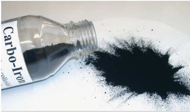
Das am UFZ entwickelte Carbolron™ ist ein Verbundmaterial aus Mikroaktivkohle und Nanoeisen. Carbolron wurde für den direkten Einsatz in belasteten Grundwasserleitern optimiert. Foto: Dr. Robert Köhler/UFZ
