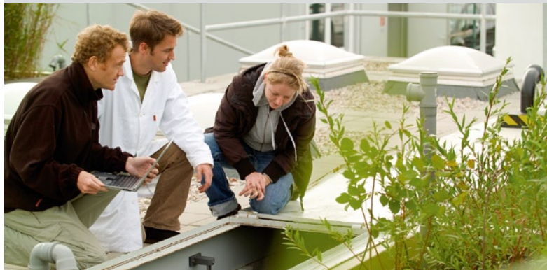
UFZ-Pilotanlage Compartment Transfer (COTRA) in Leuna, Sachsen-Anhalt. Ein zu den Einfachtechnologien zählendes Verfahren ist das Konzept des Compartment Transfers. Nach diesem Konzept wird ein Schadstoff von einem Umweltkompartiment, beispielsweise Grundwasser, in dem er schwer abbaubar ist, in ein anderes Kompartiment überführt, wie die Atmosphäre, wo er schneller abbaubar ist.
