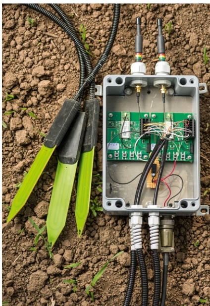
Für das Langzeitmonitoring verschiedener mikroklimatischer Parameter wird ein drahtloses Sensornetzwerk entwickelt und eingerichtet. Die Sensorknoten sind so ausgelegt, dass auch in Zukunft unterschiedlichste Sensoren implementiert werden können. Ein Gewirr ober- und unterirdischer Kabel wäre auf der GCEF undenkbar, da viele Flächen mehrmals im Jahr mit landwirtschaftlichen Geräten befahren werden müssen. (Foto: André Künzelmann, UFZ)
